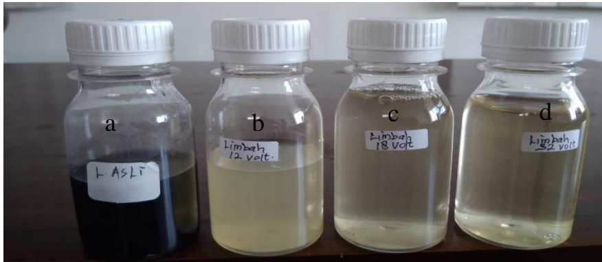
Gambar 2. Hasil dari pengolahan limbah batik (a). Limbah batik asli sebelum diolah, (b)Tegangan 12 volt, (c) Tegangan 18 volt, (d) Tegangan 32 volt.
